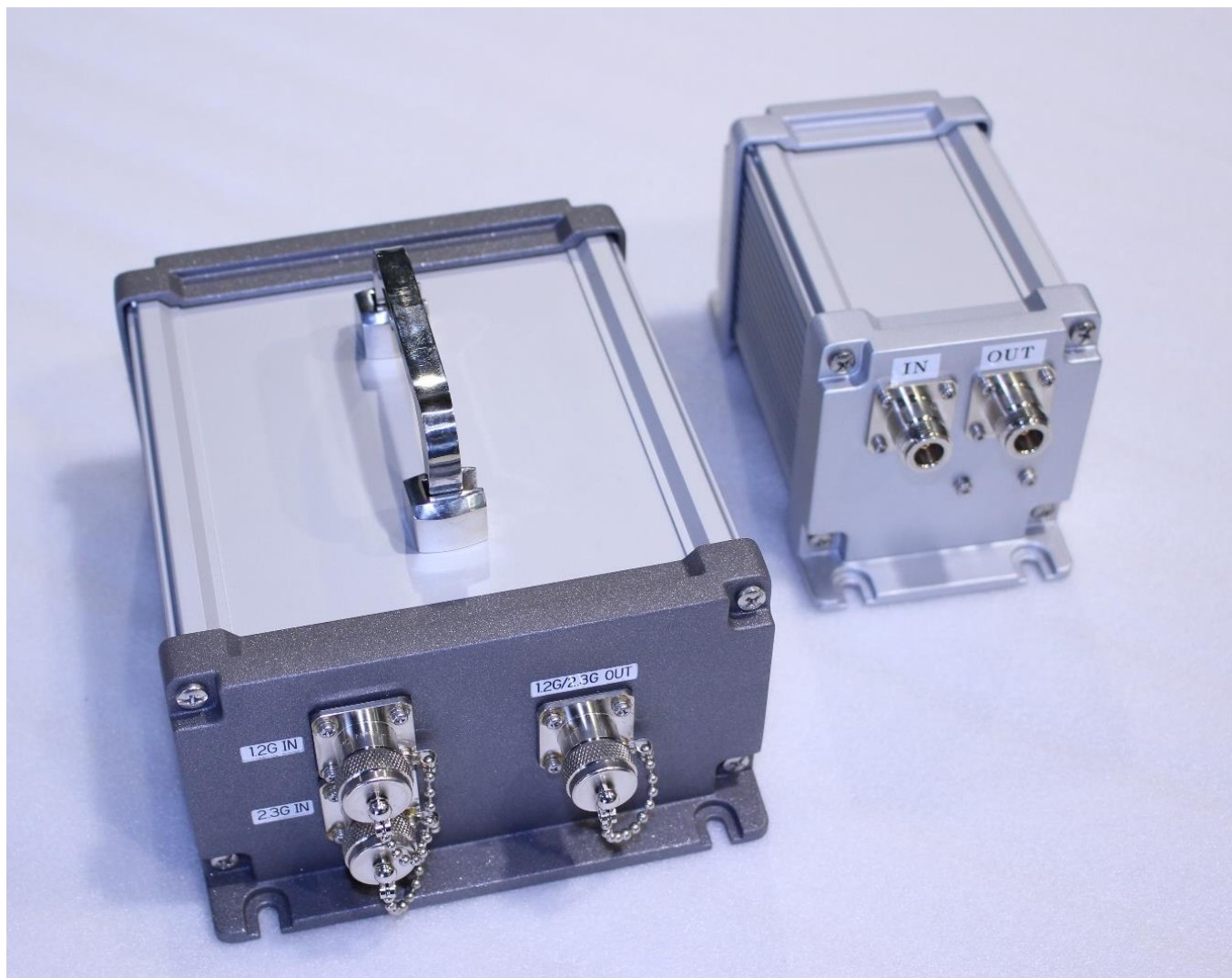
基地局用LNA(左側)
